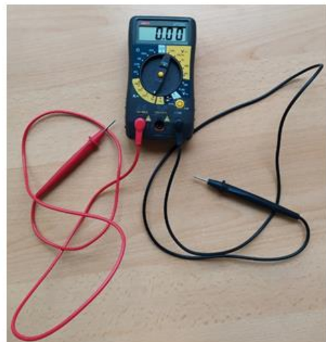
univerzálny merací prístroj na meranie elektrických veličín
